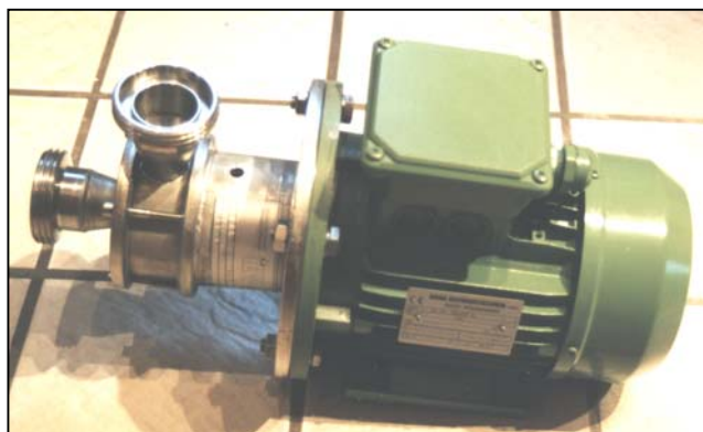
Abb.: Inliner Typ USL-65 mit Siebeinsatz
